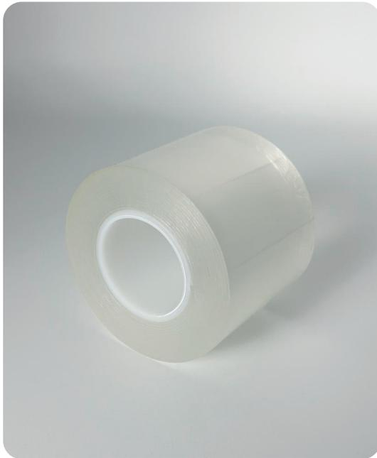
EGJ-SD280 硅橡胶光学界面专门用于光电传感器和闪烁晶体之间的光学耦合。该硅橡胶材料非常柔软,能够适应曲面连接。它是一种完全固化的聚合物,表面略带粘性,在轻微压力下可以变形。同时,它不像润滑油一样流动,不会在压缩时不可逆地被挤出,非常适合长期耦合闪烁晶体和光电倍增管 / 硅光电倍增管。使用刀片或剪刀很容易就能将 EGJ-SD28 硅橡胶薄片材料剪成所需尺寸。所有 EGJ-SD280 产品在出厂时表面都会覆盖一层容易去除的薄膜。EGJ-SD280 橡胶可以很容易沾在任何光滑的表面上,也很容易剥离,不会损坏部件。EGJ-SD280 表面沾上灰尘,其粘合性能会降低。
