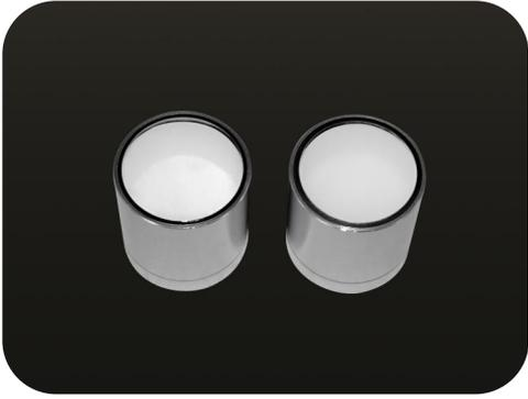
CLLB( $\text{Cs}_2^6\text{LiLaBr}_6:\text{Ce}$ ) 晶体, 以其卓越的闪烁性能在中子探测领域独树一帜。其显著特点包括: 高密度 ( $4.2 \text{ g/cm}^3$ )、极高的中子光产额 ( $>180,000 \text{ neutron/MeV}$ )、优秀的能量分辨率 (2.8-4%)、出色的中子/伽马甄别能力 (FOM: 1.2-2)、高效的中子吸收率 (85%) 以及极佳的能量线性变化 (小于 2%, 20~600keV), 在已知所有闪烁体中表现最优。此外, 其闪烁性能的温度稳定性亦十分出色。CLLB 晶体是唯一同时具备高中子与伽马光产额的无机闪烁晶体, 因其对高中子和伽马极高的光产额, 被视为小型化中子探测的理想材料。该晶体在核素识别仪 (RIID)、个人辐射剂量仪 (SPRDs)、伽马相机、空间研究及高能物理等核辐射探测领域展现出广阔的应用前景, 相关产品已在行业内得到广泛认可和应用。
