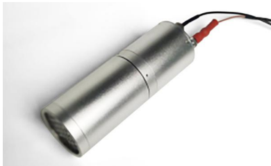
a) 表面污染测量探头搭配分压管座测试图
