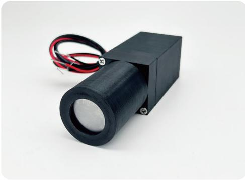
ENAI-D25H02XD NaI X 射线探测器是由 NaI 闪烁体 (铍窗)、光电倍增管、前置放大器、高压电源等组成。该探测器具有 X 射线探测下限低、使用简单、可靠性高等特点,被广泛应用于工业探测、放射医疗、X 射线荧光分析等领域。
