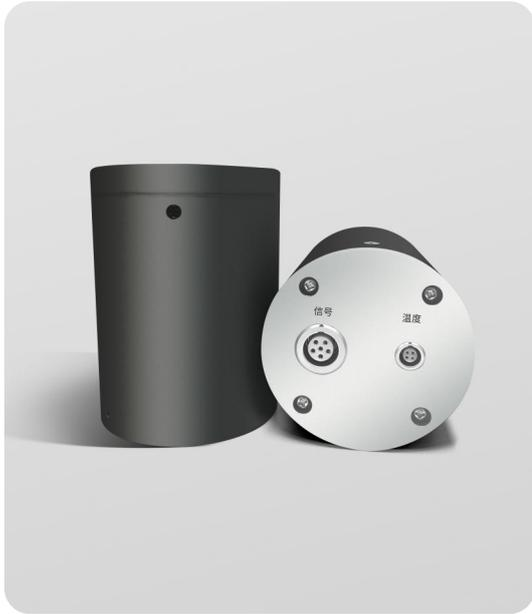
EP-PDMCA1100A 能谱分析数字多道是一款内置数字化多道脉冲幅度分析功能和能谱分析功能的混合系统，主要用于适配 NaI、LaBr<sub>3</sub>、BGO 等各种闪烁探测器的能谱读数。波形全采样技术将预放大信号直接数字化，通过内部集成的高压控制、调零、调幅、温度采集等功能采集能谱数据，再通过高性能芯片完成能谱分析。内置的能谱稳定算法可保持能谱的长期稳定性。使用高斯拟合法和阶跃函数法计算净峰面积，可实时返回能谱分析结果，包括核素识别和活度计算功能。
